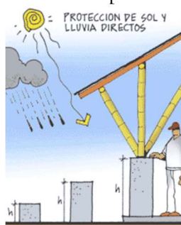
Figura 148 - Proteção das bases dos pilares contra a umidade.
