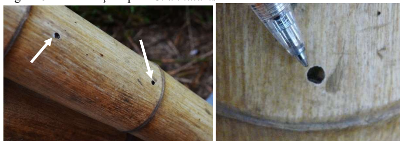
Figura 62 - Perfurações pelo C. annularis no Estudo de Caso 2.
