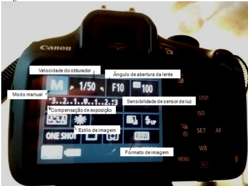
Figura 18: Configuração da câmera CANON para padronização da captura das imagens
