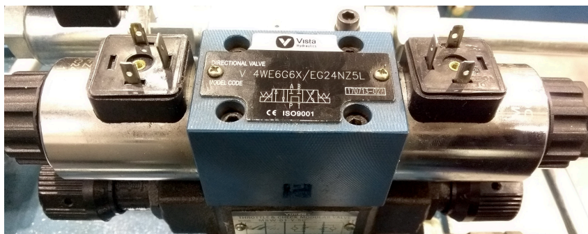
Figura 20 – Válvula hidráulica sobre as válvulas reguladoras de fluxo.
