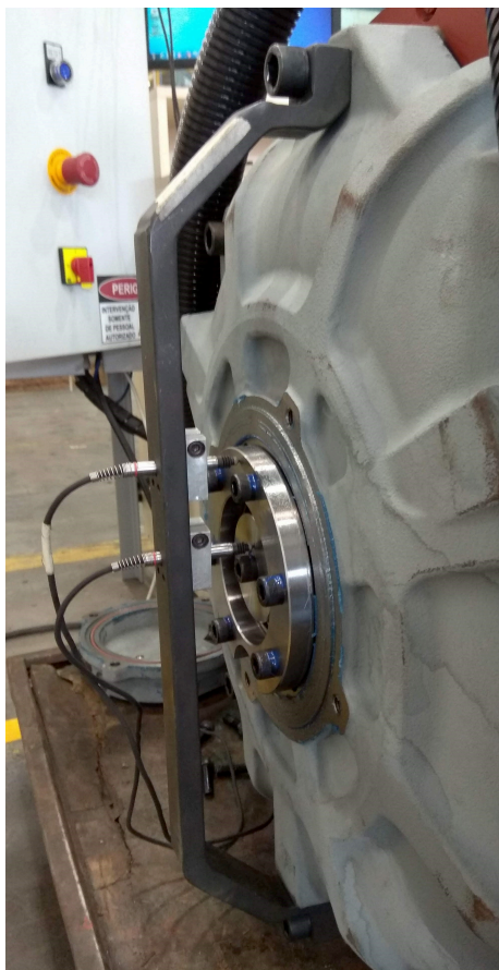
Figura 31 – Montagem do suporte metálico com os sensores de deslocamento.
