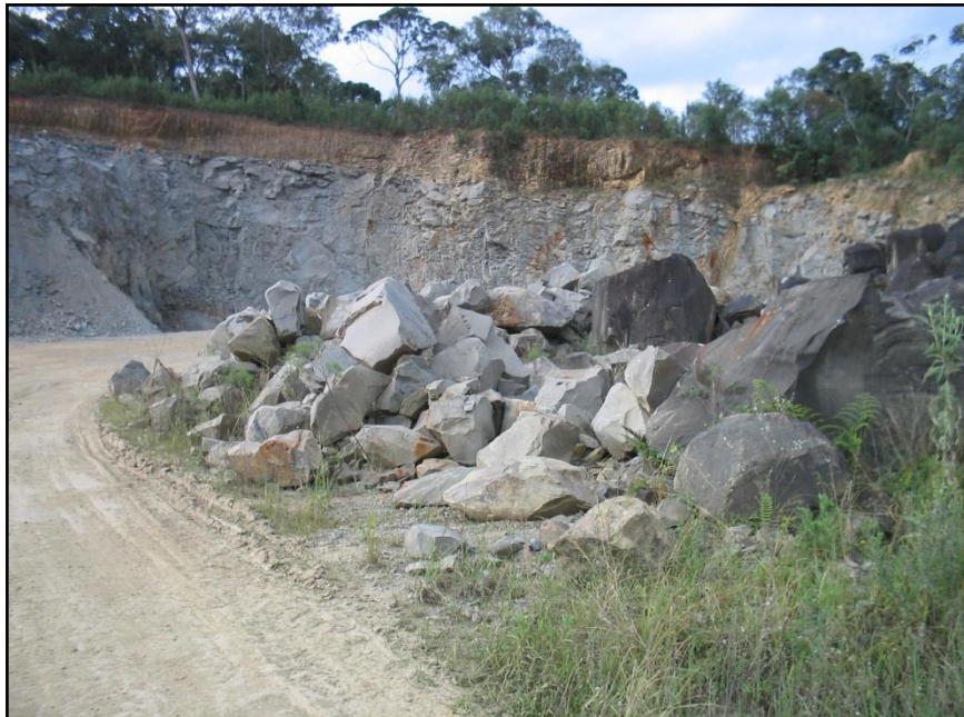
Figura 1. Vista norte para frente de lavra. O capeamento de solo estéril mostra-se na cor marrom claro, e o diamictito, na cor cinza claro do maciço.
