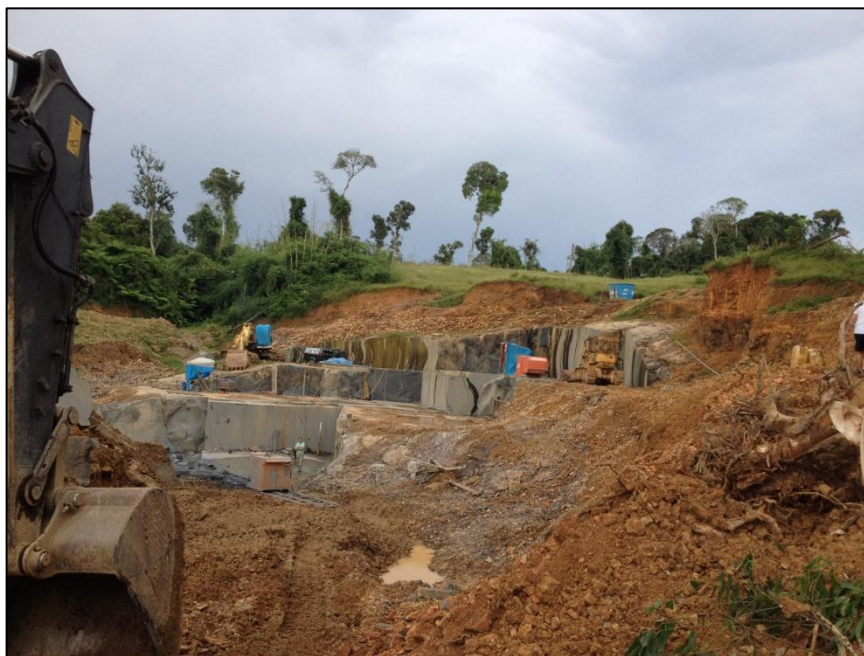
Figura 3. Frente de lavra em operação. A extração do material (diabásio em cor cinza) é realizada através de blocos por máquina de corte com fio diamantado.
