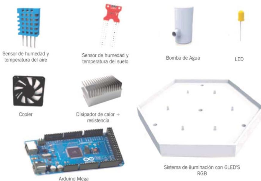
**Figura 6: Componentes Electrónicos. Fuente: elaborado por los autores.**
