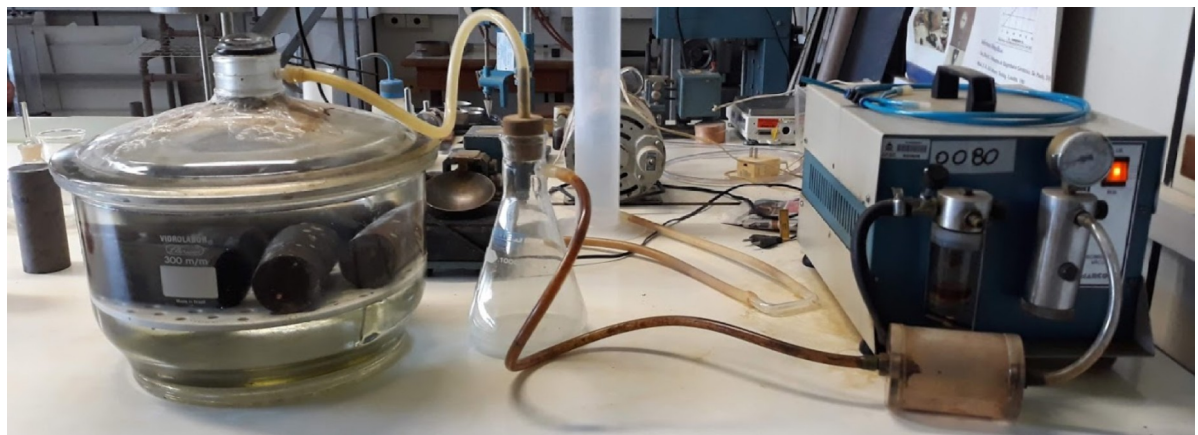
Figura 25: Saturação dos corpos de prova. À esquerda, o recipiente contendo os corpos de prova imersos em água. À esquerda, a bomba de vácuo utilizada.
