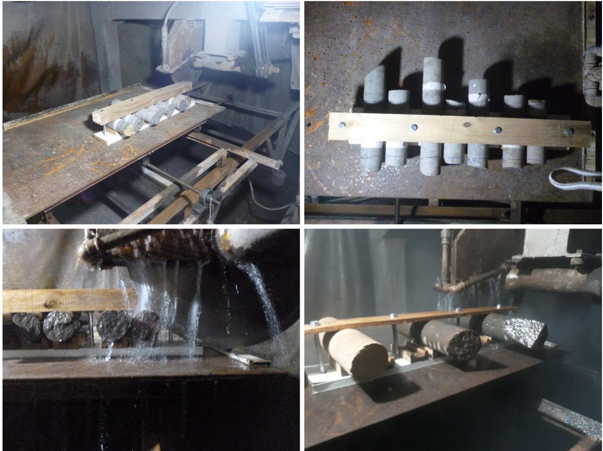
Figura 20: Equipamento utilizado para o corte dos corpos de prova.
