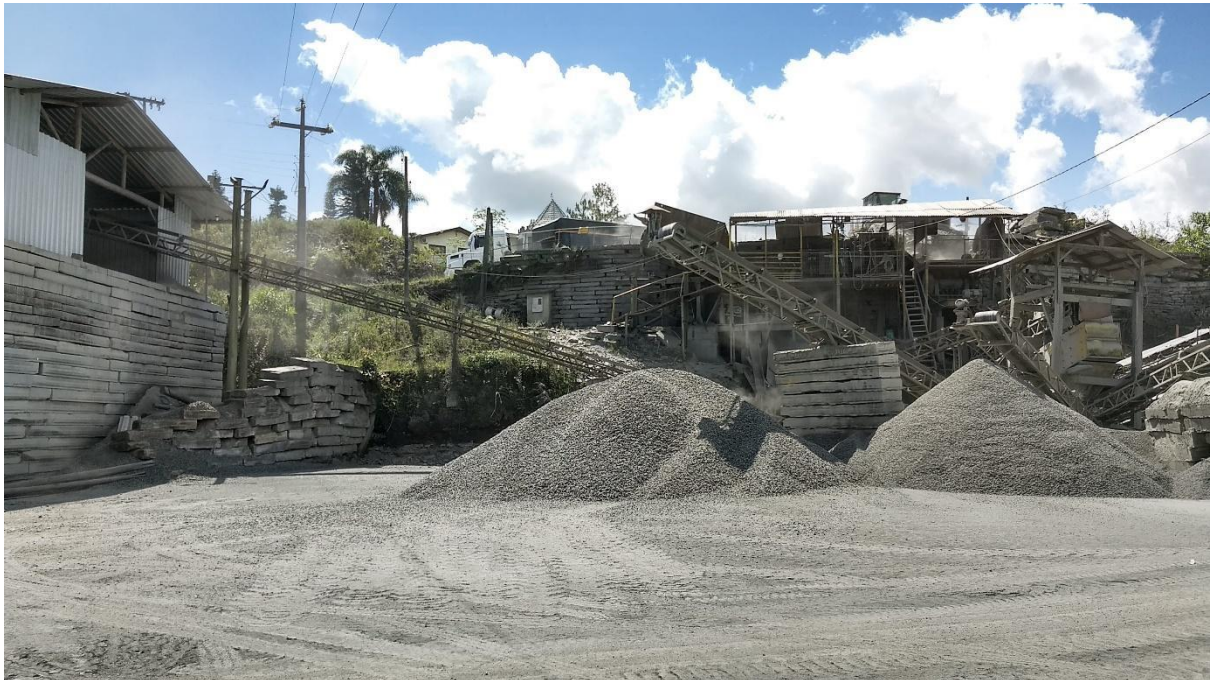
Figura 5: Planta de beneficiamento automatizada utilizada pela Mineração Castelinho, na cidade de Trombudo Central/SC para a geração de variadas frações do varvito.
