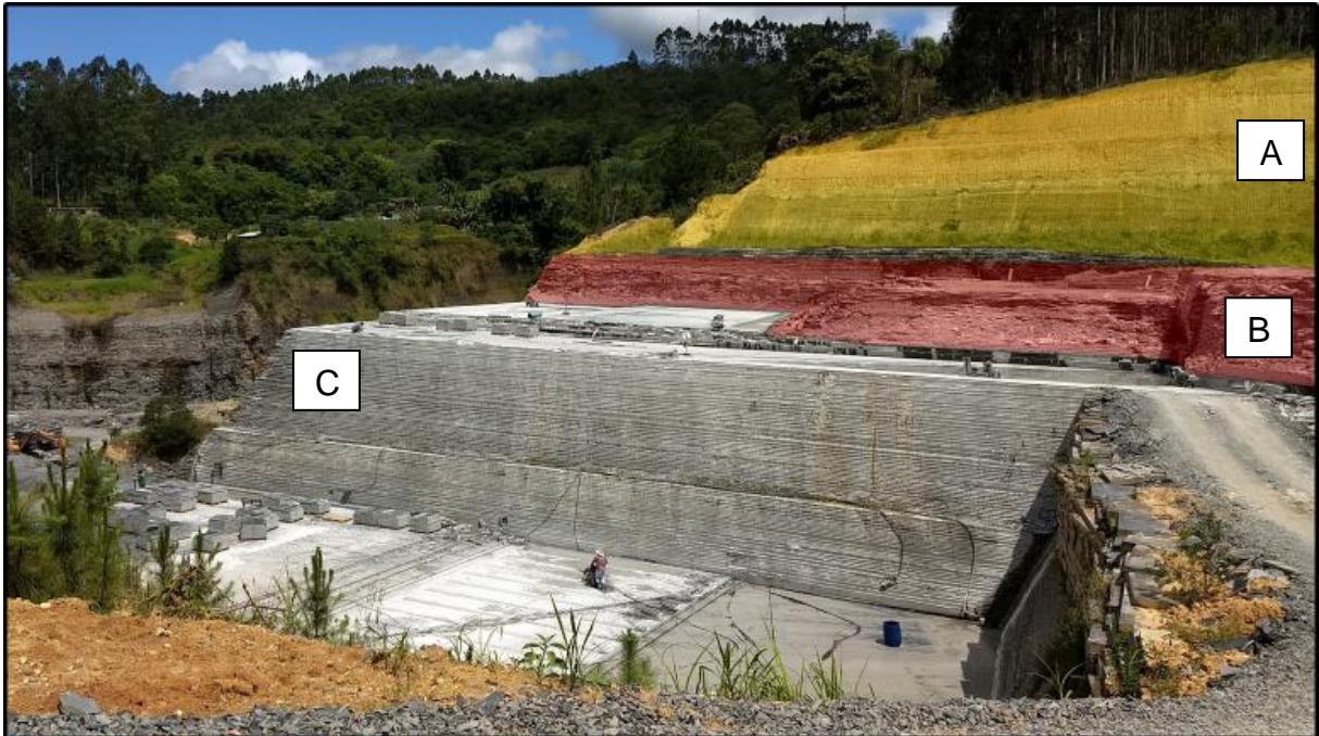
Figura 16: Frente de lavra da mina Castelinho com destaque para UNIDADE III, formada pelas litofácies PTC – 1K (A), PTC - 1J (B) e PTC – 1I (C).
