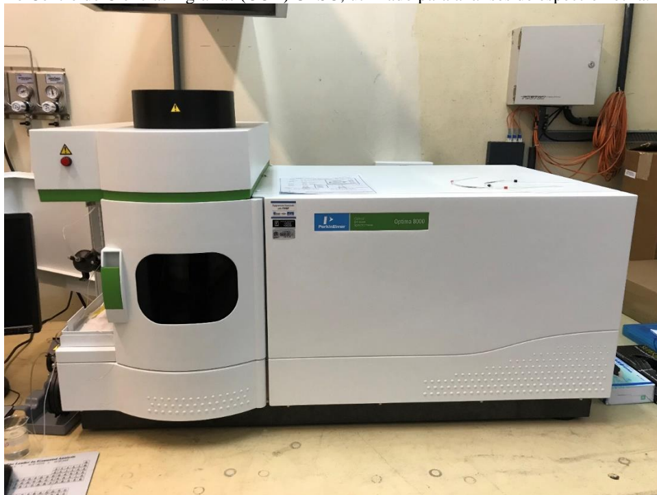
Figura 11: Equipamento ICP - OES Optima Série 8x00, do Laboratório de Solos, Água e Tecidos Vegetais localizado no Centro de Ciências Agrárias (CCA) UFSC, utilizado para análises de espectrometria.
