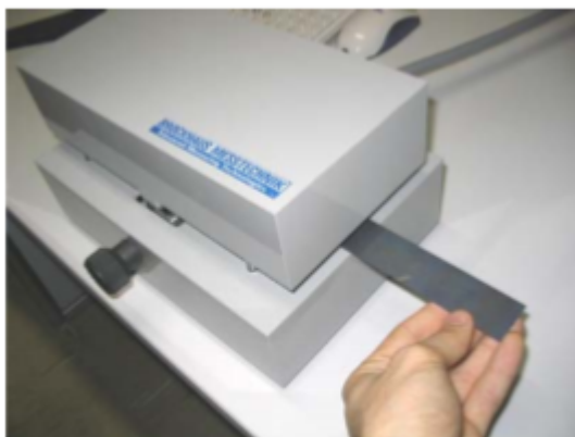
Figura 5 – Equipamento de medida SST – Single Strip Tester
