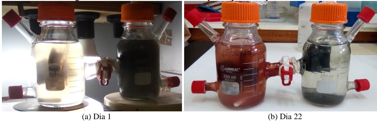
Figura 12 – CCM construída na etapa de pré-enriquecimento.
