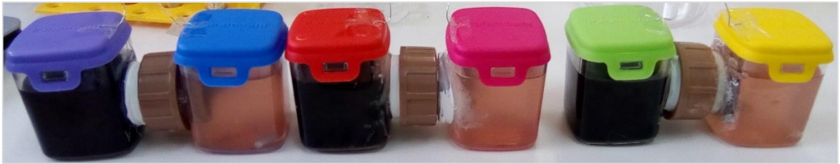
Figura 13 – Construção das CCMs.
