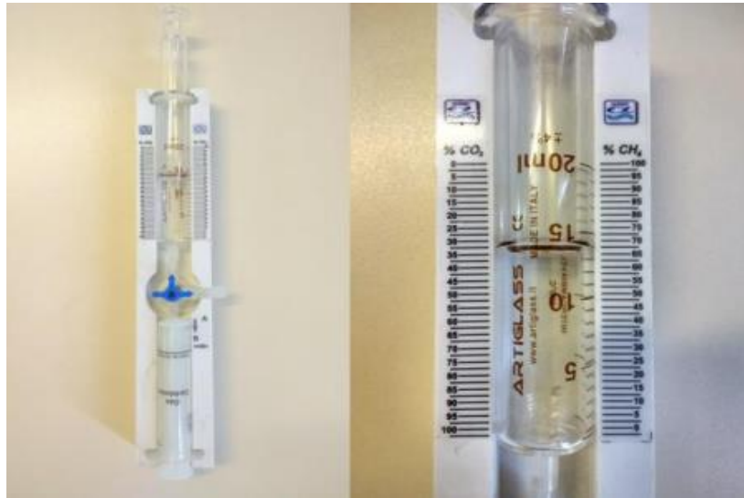
Figura 10 – Suporte de análise de CO 2 e CH 4 que compõem o kit de análise do biogás da Alfakit.
