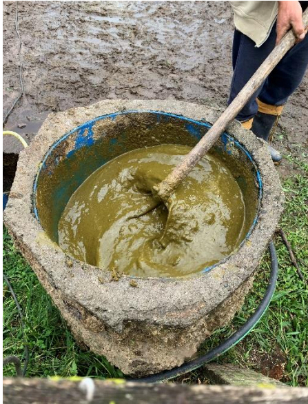
Figura 7 – Caixa de entrada biodigestor.
