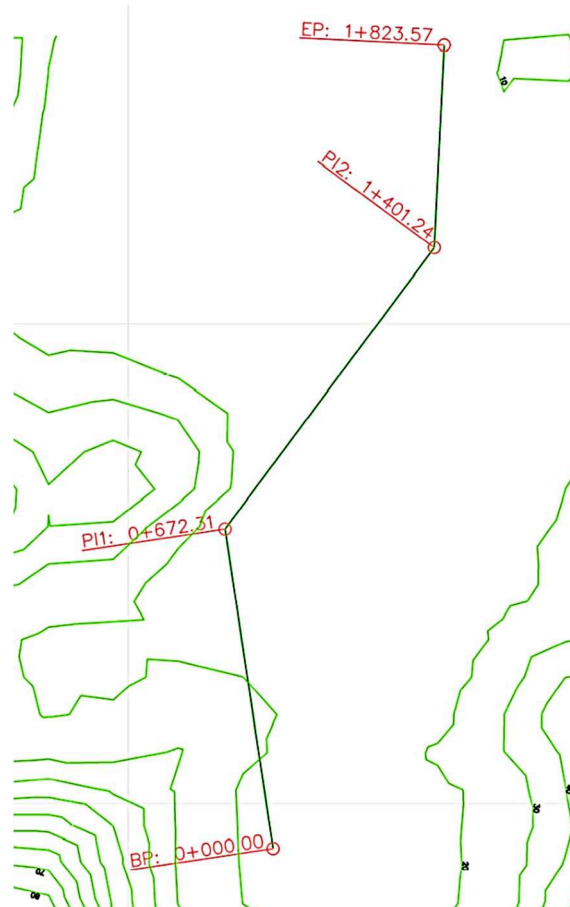
Figura 10. Representação dos pontos inicial, final e de interseção das tangentes da rodovia hipotética
