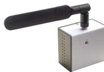
Figura 3 – End device LoRa® NIT 21 LI. Fonte: (KHOMP, 2019b).
