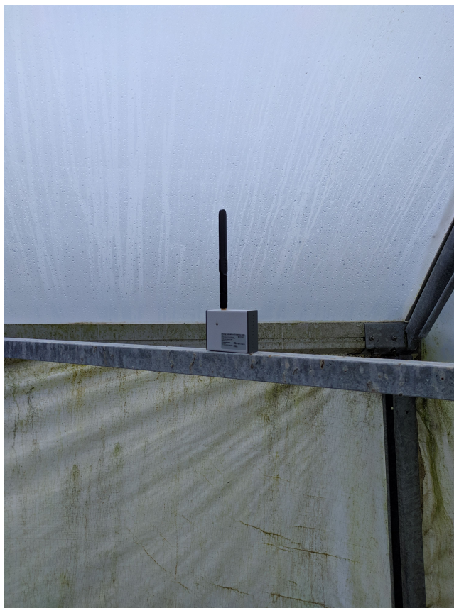
Figura 16 – Foto do end-device LoRa® durante as medidas. Fonte: Elaborado pelo autor.
