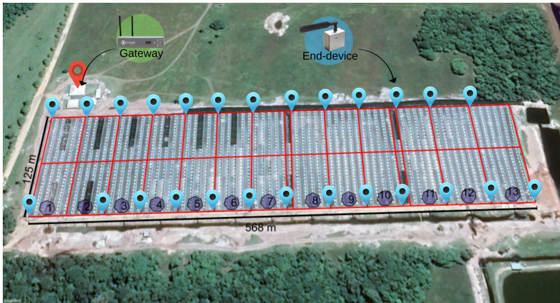
Figura 7 – Posicionamento do gateway e dos pontos onde serão feitas as medidas. Fonte: Elaborado pelo autor.
