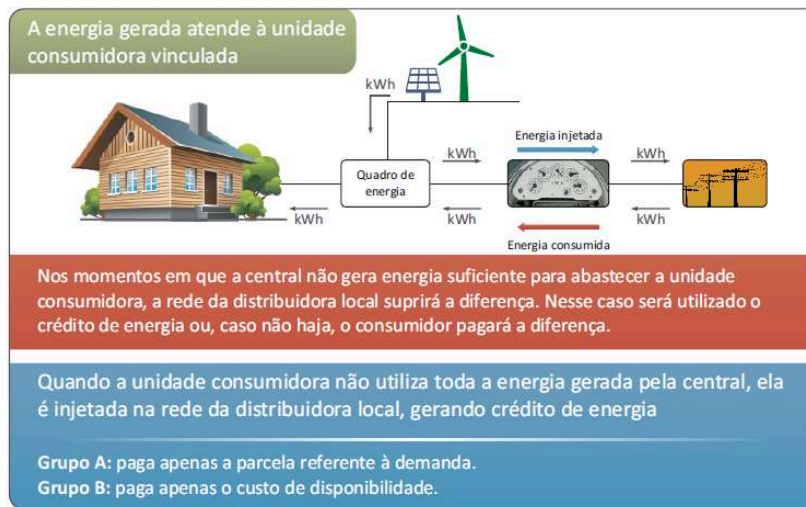
Figura 4 – Sistema de compensação de energia elétrica
