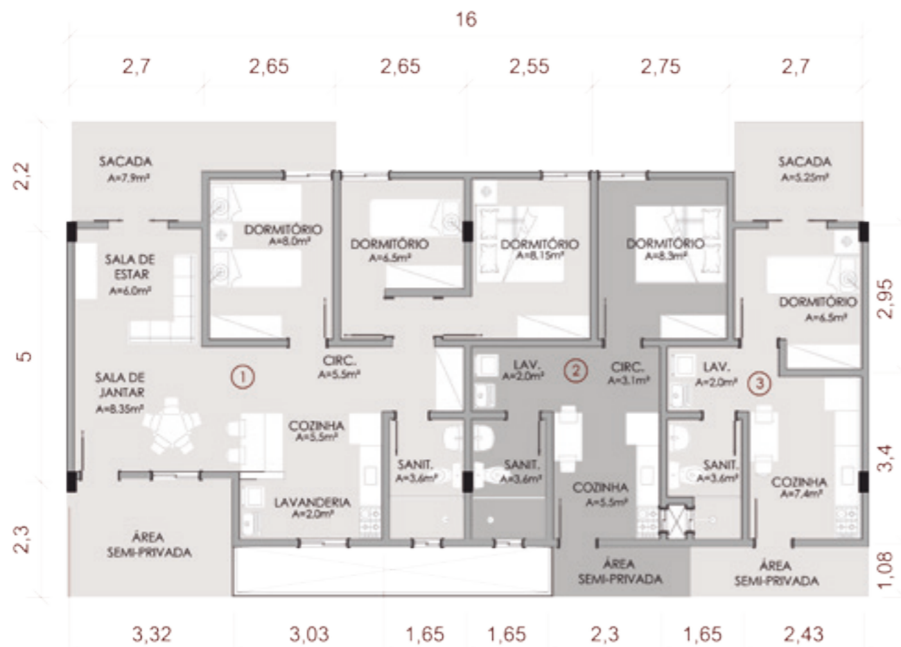
TIPOLOGIA 1: 3 dormitórios | TIPOLOGIA 2: 1 dormitório | TIPOLOGIA 3: 1 dormitório ÁREA: 63,25m 2 | ÁREA: 23,15m 2 | ÁREA: 26,25m 2 ESC.: 1/100
