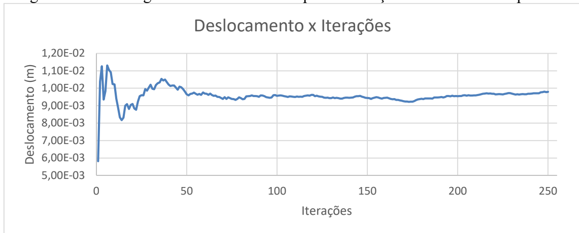
Figura 31 – Convergência do deslocamento para a variação do índice de compressão.
