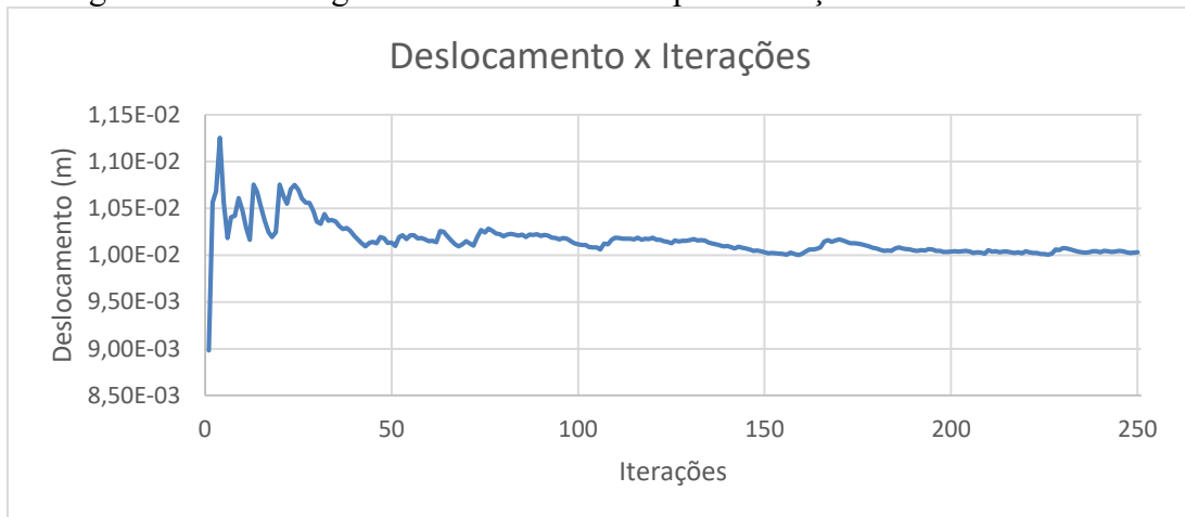
Figura 29 – Convergência do deslocamento para variação do índice de vazios.
