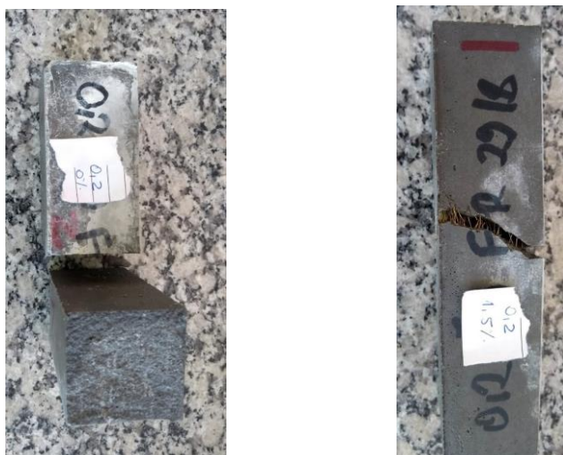
Figura 18 – Ruptura dos CPs no ensaio de tração.
