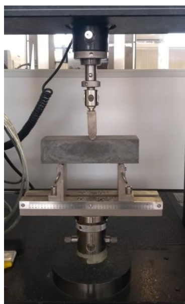
Figura 11 – Montagem do ensaio de tração na flexão.
