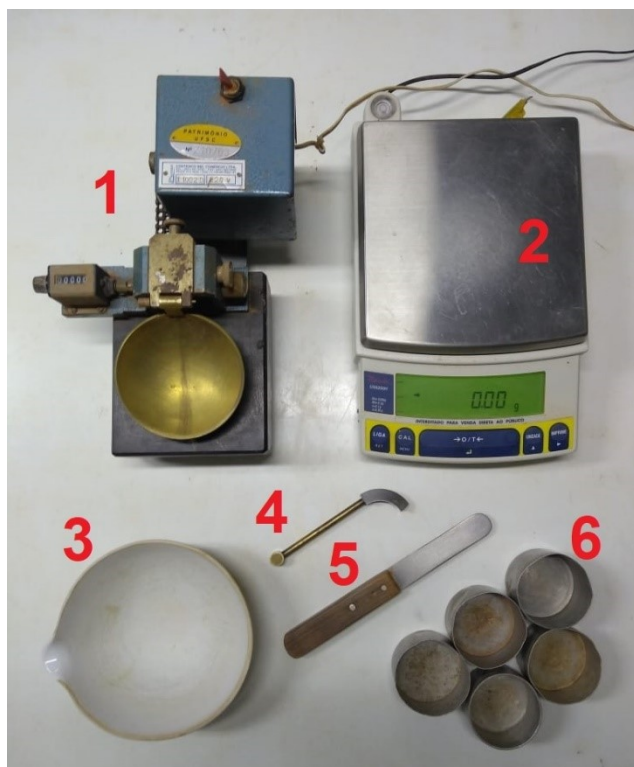
Figura 6 - Aparelhagem para execução do ensaio de Limite de liquidez (acervo pessoal)
