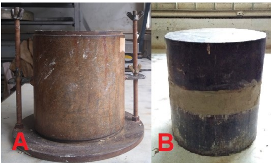
Figura 15 – Método de carregamento prévio (A) Cilindro de compactação (B) espaçadores metálicos
