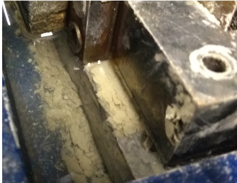
Figura 30 - Perda de material no Estágio 03 - Espatulamento
