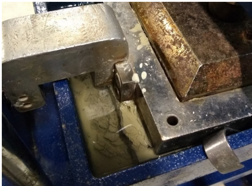
Figura 35 - Perda de material na Ida 01 no Carregamento prévio
