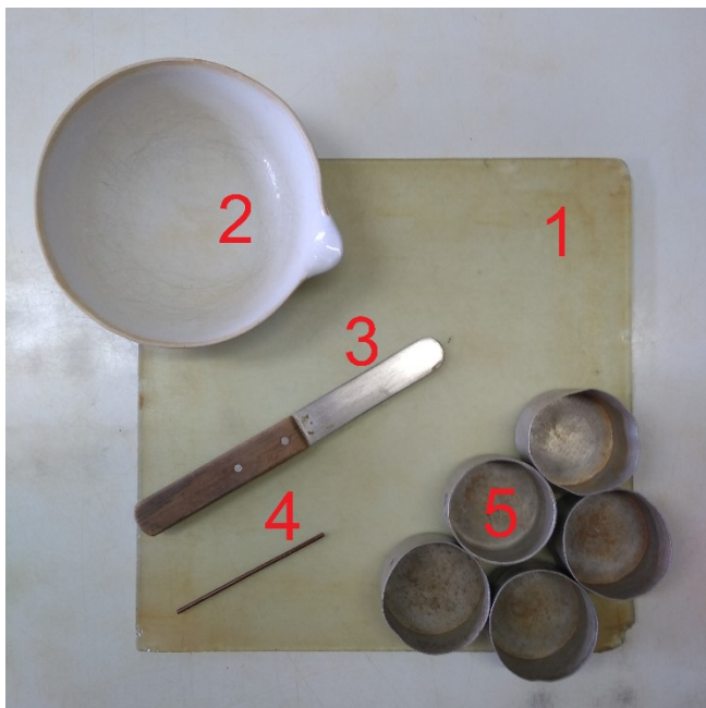
Figura 10 - Aparelhagem para execução do ensaio de Limite de plasticidade (acervo pessoal)
