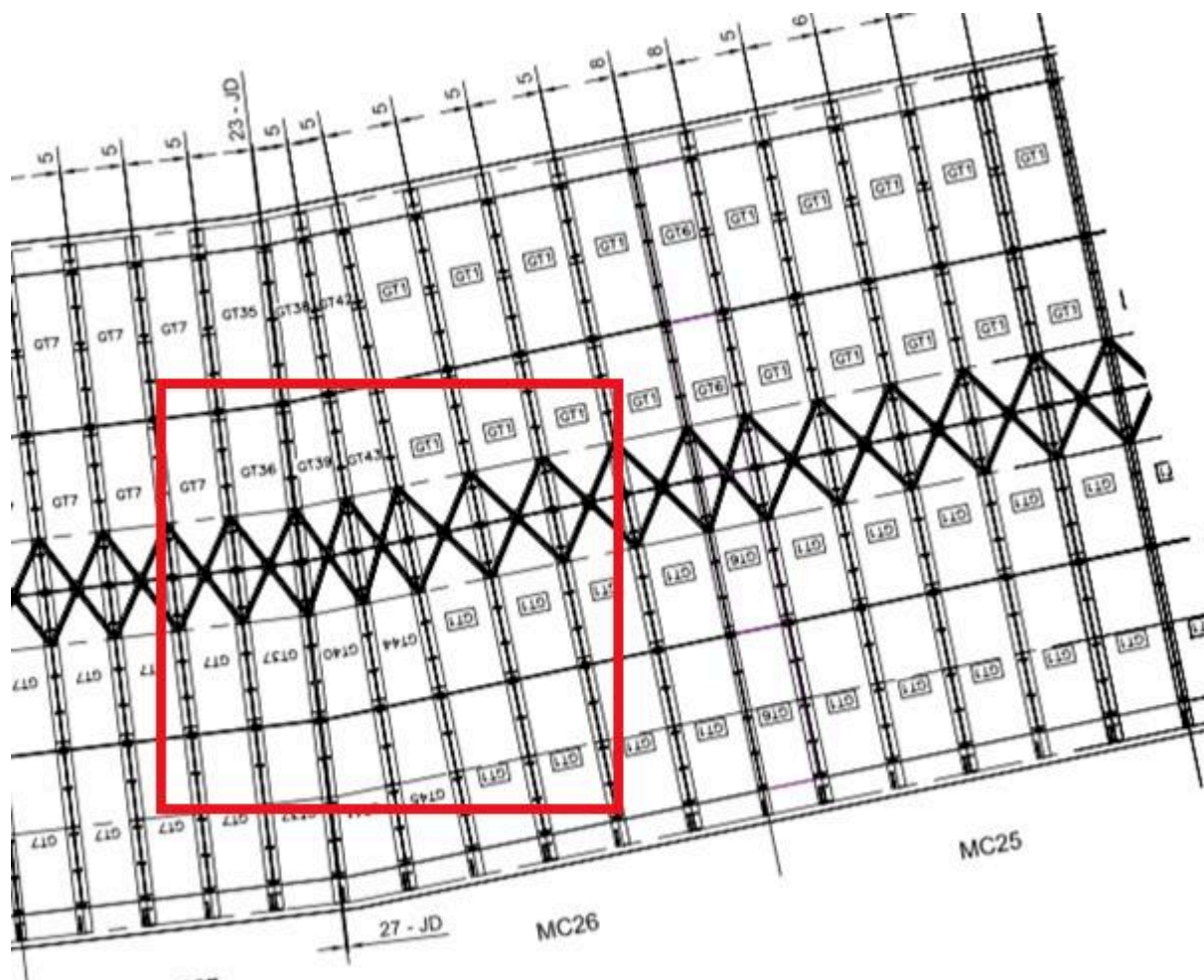
Figura 28 – Detalhe do projeto de paginação do Viaduto Continental – Módulos MC26 e MC25
