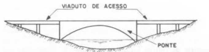
Figura 16 – Viadutos de acesso em uma ponte.
