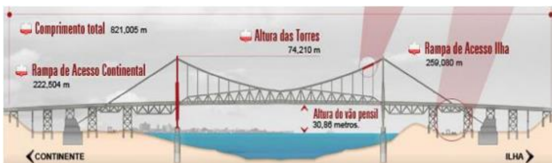
Figura 15 – Principais partes constituintes da PHL.
