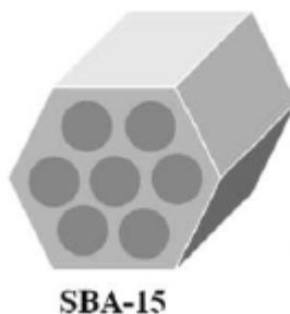
Figura 01: Estrutura hexagonal da SBA-15. Fonte: Adaptado de Miele, P. 10
