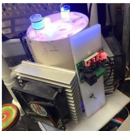
Figura 4. Fotorreator UV com emissão máxima em 400 nm.
