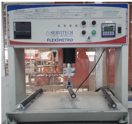
Figura 8. Flexímetro para ensaio de carga de ruptura e resistência mecânica a flexão.
