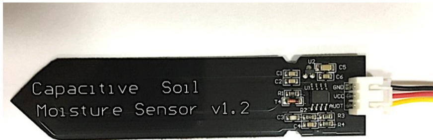
Figura 9 - Sensor de umidade do solo utilizado como componente adicional ao lisímetro de pesagem.
