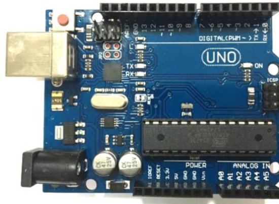
Figura 2 – Placa Arduino UNO utilizada para o desenvolvimento do lisímetro de pesagem.
