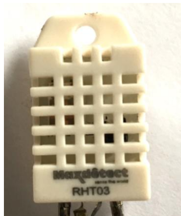
Figura 4 - Sensor de temperatura e umidade do ar (RHT03) utilizado como componente adicional ao lisímetro de pesagem.
