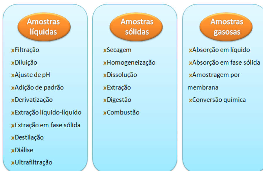
Figura 3 - Procedimentos de preparo de amostra comumente utilizados para análises por IC, com base no estado físico da amostra.
