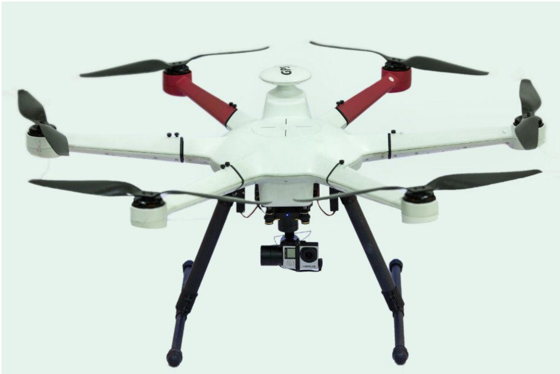
Figura 3 Exemplo de UAV do tipo sexrotor ou sexcóptero
