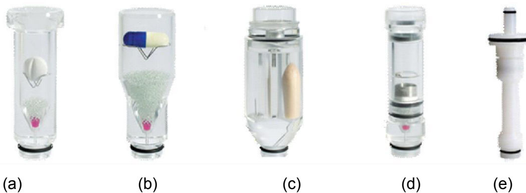
Figura 7. Alguns tipos de células de fluxo disponíveis para os ensaios de dissolução empregando o aparato USP 4. Células para (a) comprimidos, (b) cápsulas de gelatina, (c) supositórios (d) pós e grânulos e (e) stents .
