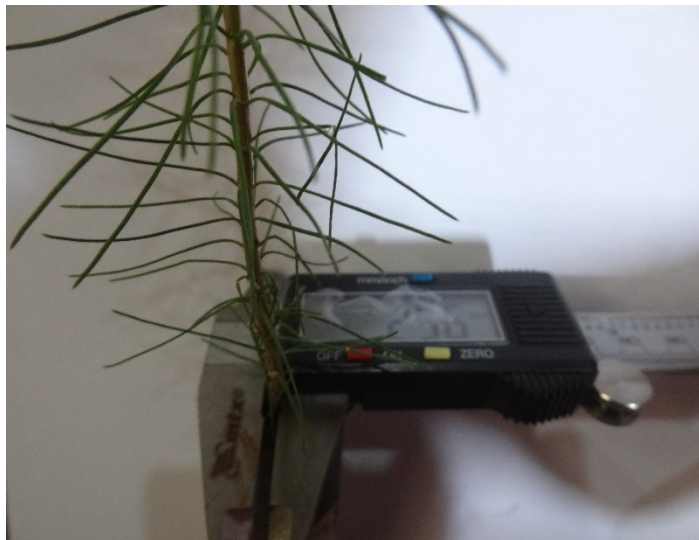
Figura 5 – Aferição do diâmetro de coleto de mudas de Pinus taeda , tomando-se como referência a borda do tubete.
