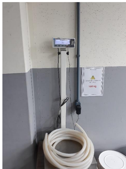
Figura 5 – Pesagem do Tubo
