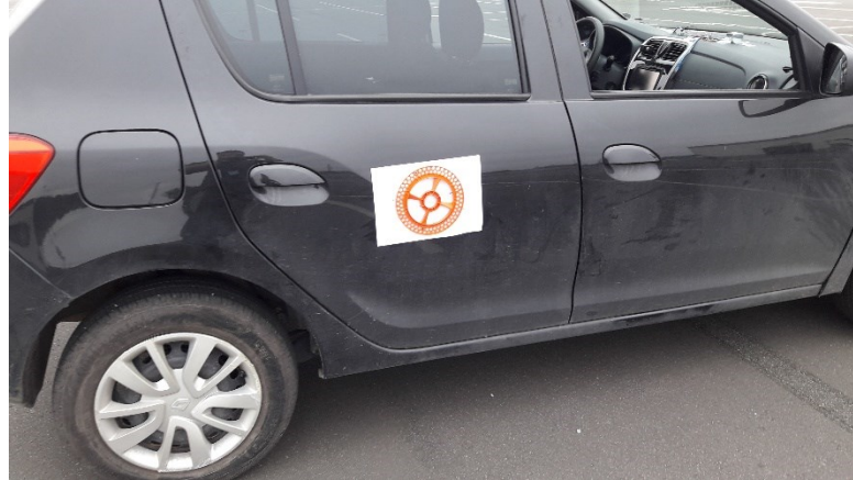
Figura 26 - Objeto de alto contraste fixado no veículo
