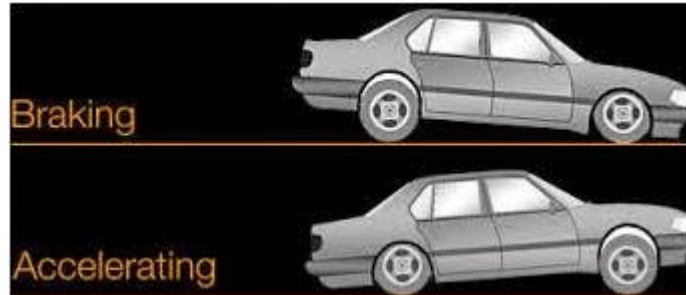
Figura 8 - Transferência de carga durante frenagem e aceleração
