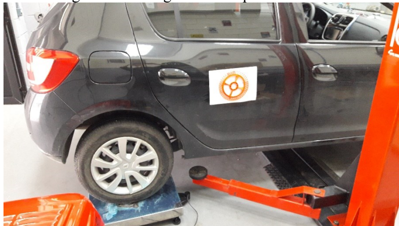
Figura 27 - Pesagem de um quarto de veículo
