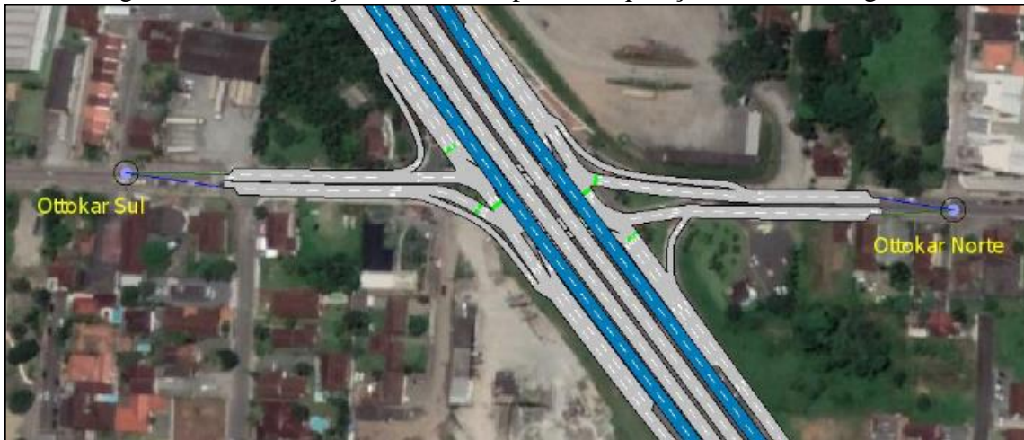
Figura 40 – Construção de viadutos para transposição das vias marginais
