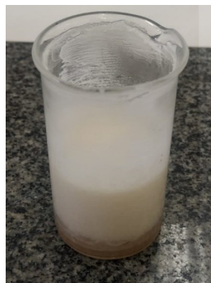
Figura 5 - Resultado experimento 2 (método à quente): Visível separação de fases.
