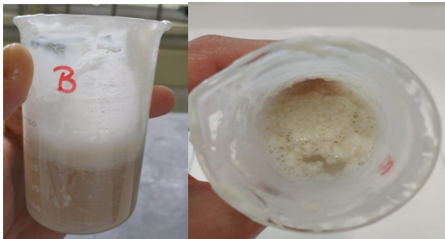
Figura 4 – Resultado experimento 1 (método à frio): visível separação de fases e formação de camada espumosa na superfície
