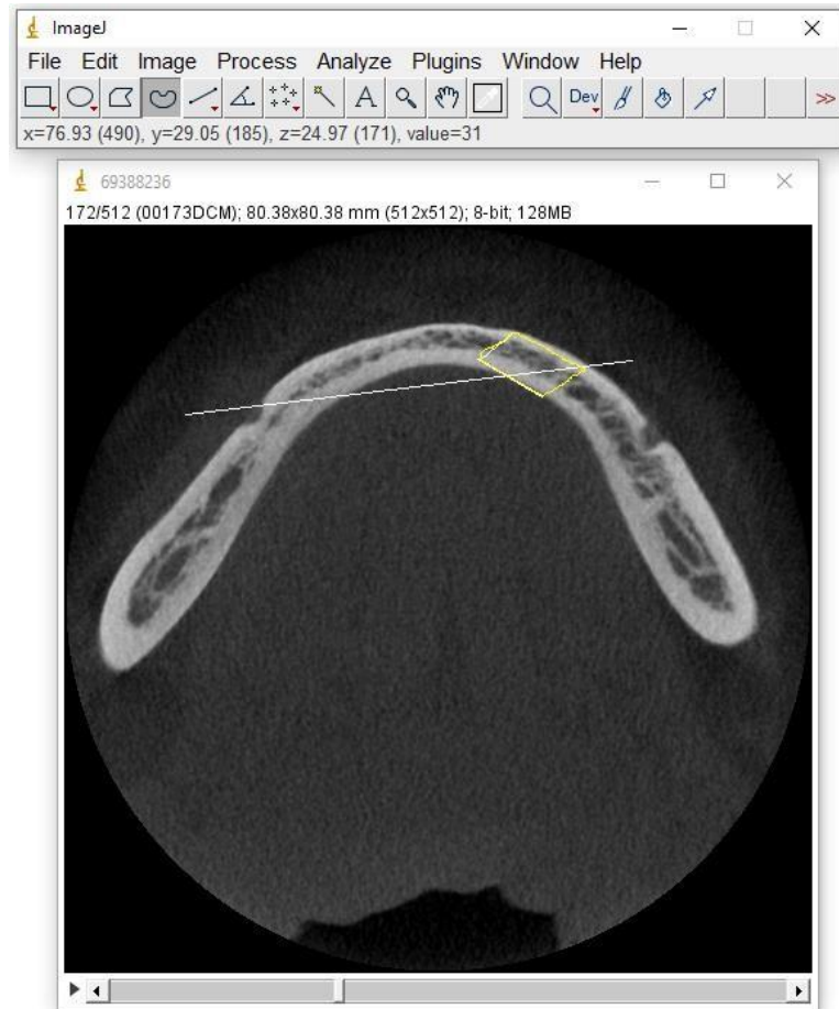
Figura 18. ROI (perímetro em amarelo) no corte axial para medição da densidade óptica. Fonte: Projeto de Pesquisa ITI-UFSC.
