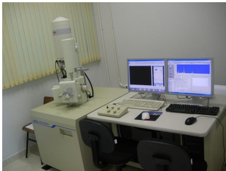
Figura 1. Microscópio Eletrônico de Varredura (JEOL JSM-6390LV, JEOL Brasil Instrumentos Científicos, São Paulo, São Paulo, Brasil) do Laboratório Central de Microscopia Eletrônica UFSC (LCME-UFSC).
