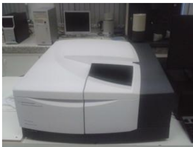
Figura 3. Aparelho Cary 660 FTIR Spectrometer do Laboratório Central de Análises do Departamento de Engenharia Química UFSC.
