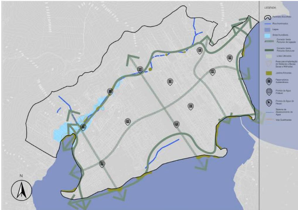
Os reservatórios podem estar encontrados na parte subterrânea de estacionamentos e praças. Serve para conservar água da chuva coletada pelos telhados verdes e pela canalização de drenagem urbana. Antes da água chegar ao reservatório ela deverá passar por filtros para eventual tratamento, assim poderá ser reutilizada para o uso da manutenção de áreas públicas, banheiros públicos e também na irrigação das hortas comunitárias dispostas na proposta de Consumo Consciente.
