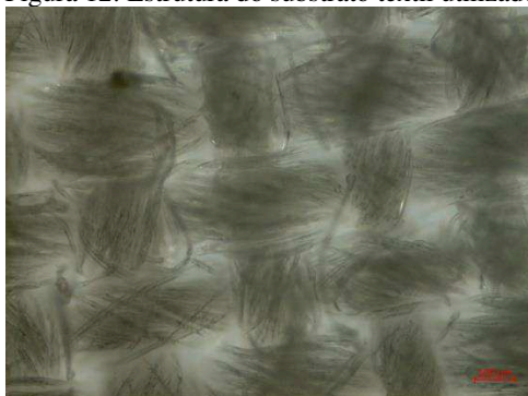
Figura 12: Estrutura do substrato têxtil utilizado na pesquisa.
