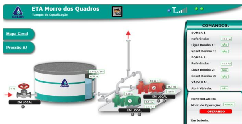
Figura 31 – Tela de monitoramento do sistema no SCADA.
