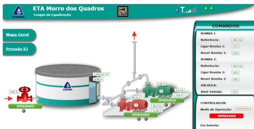
Figura 62 – Modo de operação automática do CLP.
