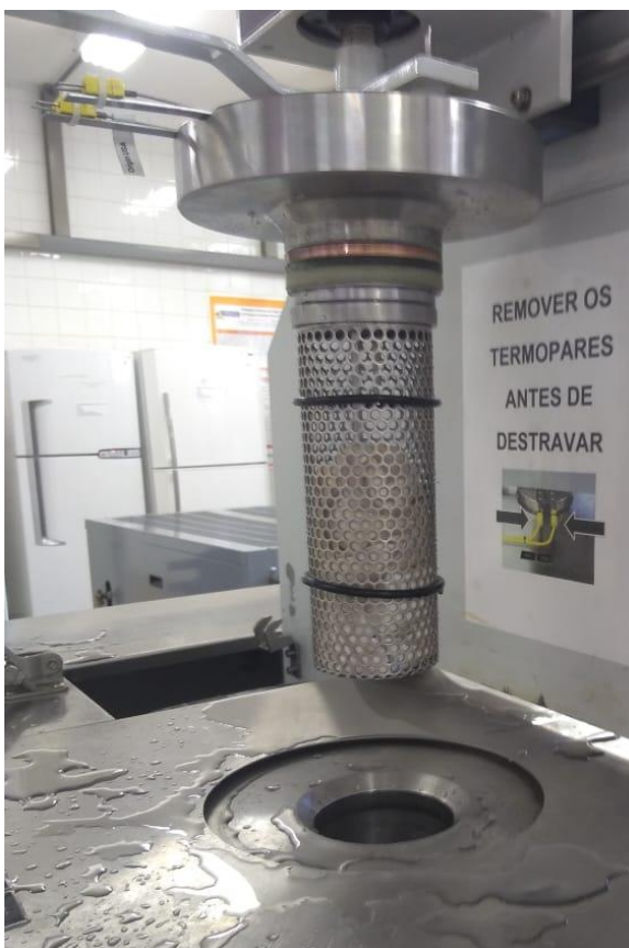
Figura 11 – Foto do vaso pressurizador do QFP 2L – 700 Avure Technologies.
