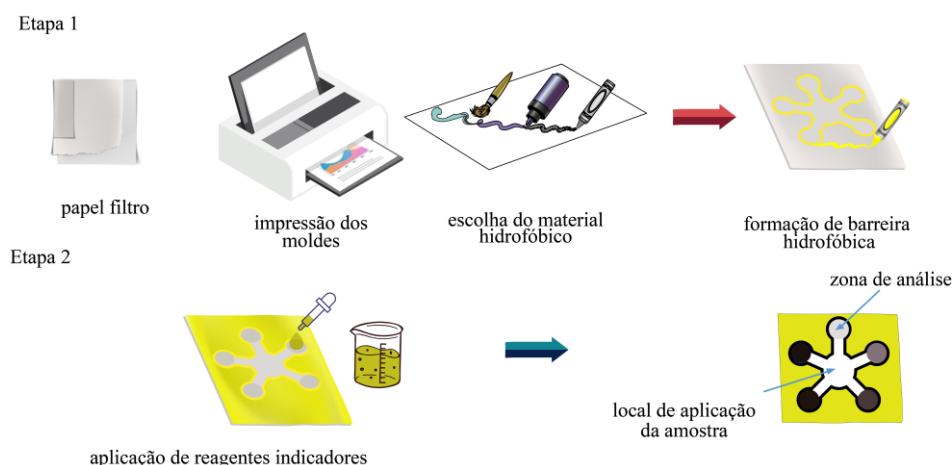
Figura 2. Esquema geral da fabricação de dispositivos de microfluídica em papel, aplicação dos reagentes indicadores nas “zonas de análise”.
