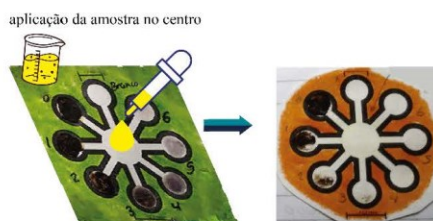
Figura 1. Representação do dispositivo de análise em papel e sua aplicação na realização do teste semiquantitativo para antioxidantes (onde 0-6 corresponde a diferentes concentrações de iodo).
