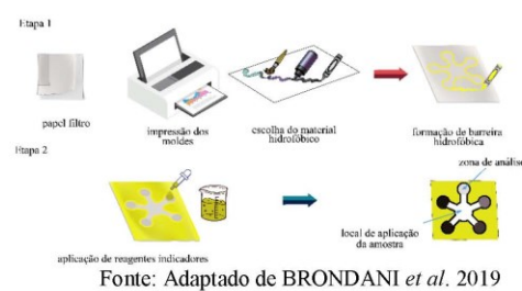
Figura 1. Esquema geral da fabricação de dispositivos de microfluídica em papel, reagentes indicadores nas “zonas de análise”.
