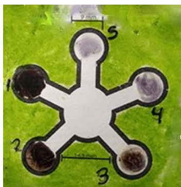
Figura 16. Padrões dos dispositivos de análise no formato de “flor”. a) Modelo de 5 pétalas; b) Modelo de 8 pétalas; c) Diferentes concentrações de iodo usadas em cada pétala.
