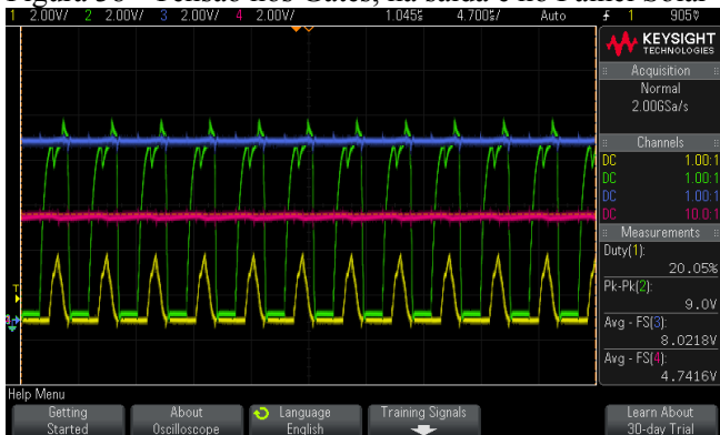
Figura 38 - Tensão nos Gates, na saída e no Painel Solar
