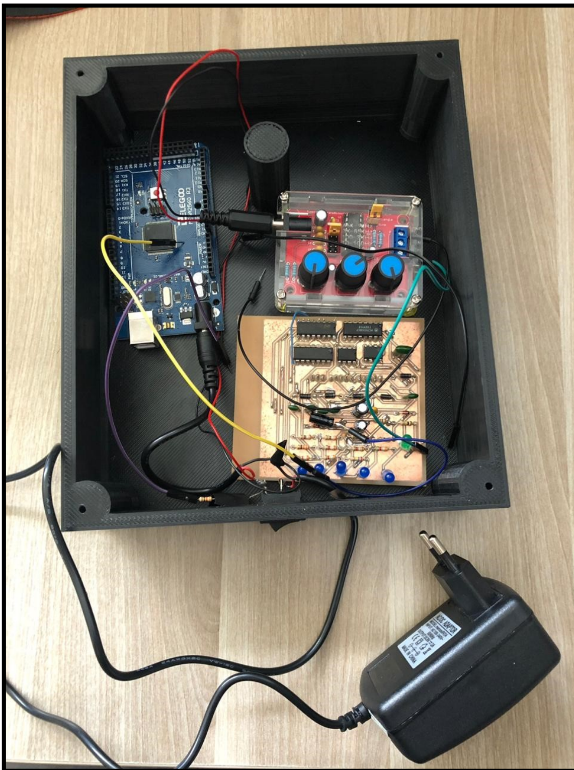
Figura 41: Arduino, gerador de sinal senoidal e PCI montada, tudo dentro da caixa (os fios foram removidos para uma melhor visão de como ficou o sistema dentro da caixa). Fonte: Elaboração própria.
