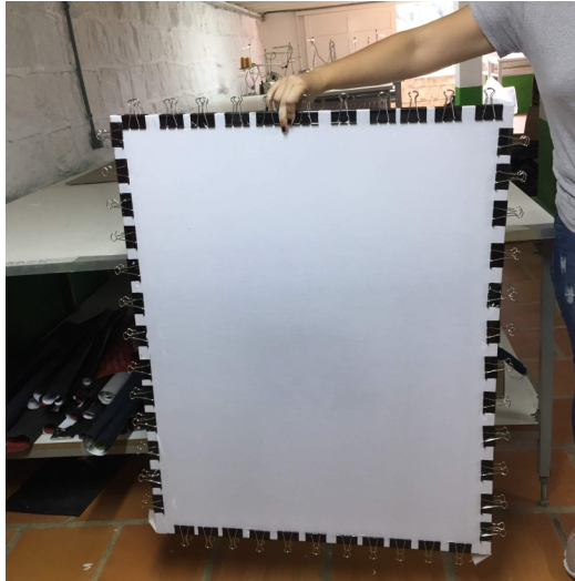
Figura 1 – Molde de tela móvel para confecção de papel reciclado, com tecido Tricoline e presilhas de papel, para confecção de papel reciclado no IFC Campus Ibirama.
