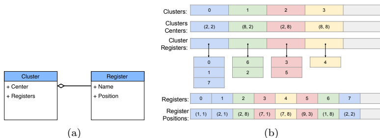
Figura 24 – Organização dos dados para estimativa do comprimento das interconexões segundo os modelos de programação OOD (a) e DOD (b).
