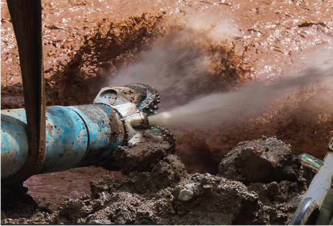
Figura 11 – Detalhe da broca de perfuração.
