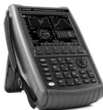
Figura 3.6 - Analisador vetorial de rede de mão RF FieldFox.
