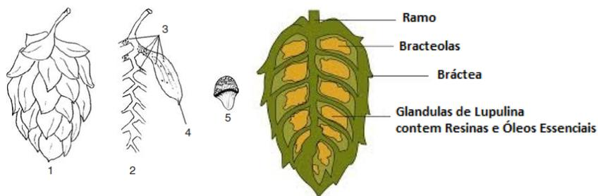
Figura 6. Desenho do cone de lúpulo à esquerda. 1) Cone integral do lúpulo; 2) Estrutura central; 3) Glândulas de lupulina; 4) Folhas; 5) Glândulas de lupulina (desenho ampliado). Corte transversal do cone do lúpulo à direita (WUNDERLICH & BACK, 2009; HIERONYMUS, 2012).
