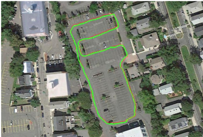
Figura 14 – Saída do ekf_localization_node (verde) na fusão de dados de odometria, duas IMUs e duas unidades GPS. A trajetória do robô como uma média dos dados brutos dos GPS é mostrada em vermelho (MOORE; STOUCH, 2014).
