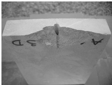
Figura 24 - Destacamento da cavilha.
