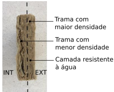
Figura 9 - Composição do isolante térmico Ventirock Duo ®.
