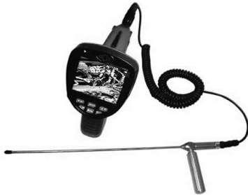
Figura 26 - Instrumentos de inspeção em regiões ocultas das fachadas com câmara de ar.
