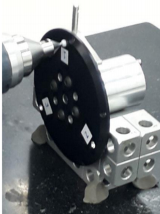
Figura 33 – Identificação da matriz de transformação da flange de medição
