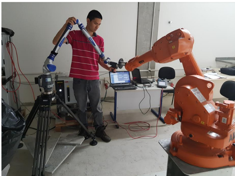
Figura 42 – Aquisição de pontos da flange de medição
