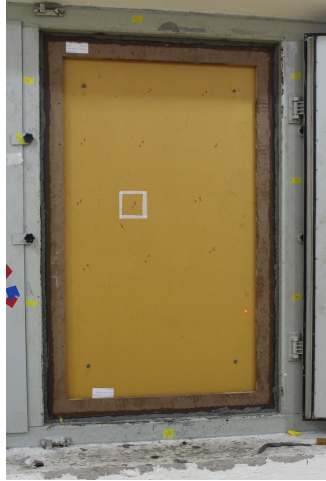
Figura 5.55: Painel montado na moldura entre as câmaras reverberantes.
