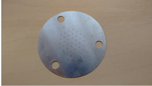
Figura 5.6: Amostra da placa rígida microperfurada a laser.
