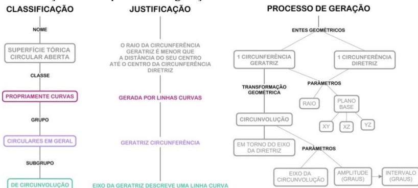
Figura 45 - Mapa com a classificação da superfície tórica, parâmetros de classificação e o seu processo de geração.
