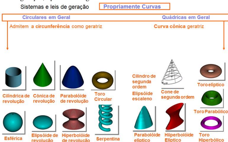
Figura 202 - Classificação de superfícies curvas a partir do parâmetro sistema e leis de geração, tipo de curva geratriz.
