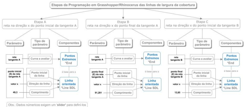
Figura 229 - Mapa conceitual com o detalhamento dos parâmetros de modelagem paramétrica das linhas de largura da cobertura do Aeroporto de Beijing.
