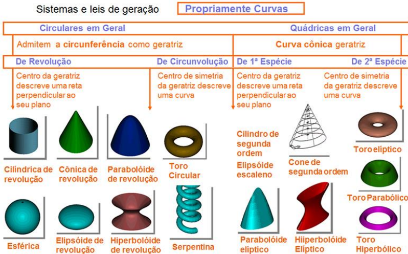
Figura 203 - Subclassificação a partir de atributos da curva geratriz relativos ao tipo de curva que descreve em seu movimento no espaço para as Superfícies Circulares em Geral e as Superfícies Quádricas em Geral.
