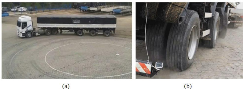
Figura 31 - CVC utilizada no estudo de caso. (a) Testes de raio de curva e velocidade constante. (b) Deflexão lateral do pneu.
